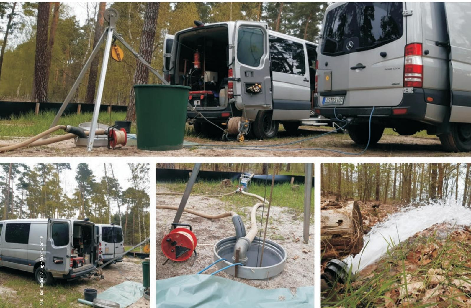
Abb. 1 – Hydrodynamische Untersuchung eines Brunnens im Rahmen einer Neubauabnahme
