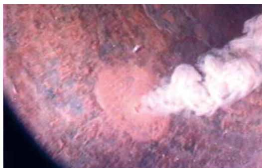
Bild 2: Perforationsloch mit Materialeintrieb
