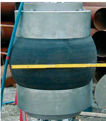
Bild 4: Druckprobe vor dem Einbau des Doppelpackers
