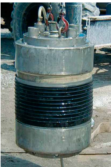
Bild 6: Für den Setzvorgang der Innenrohrmanschette vorbereiteter Einfachpacker
