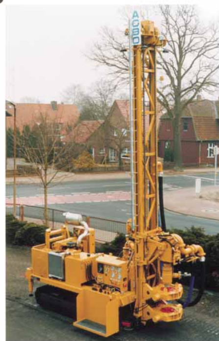
G200 mit Doppelbohrkopf, Spann- und Brecheinrichtung
